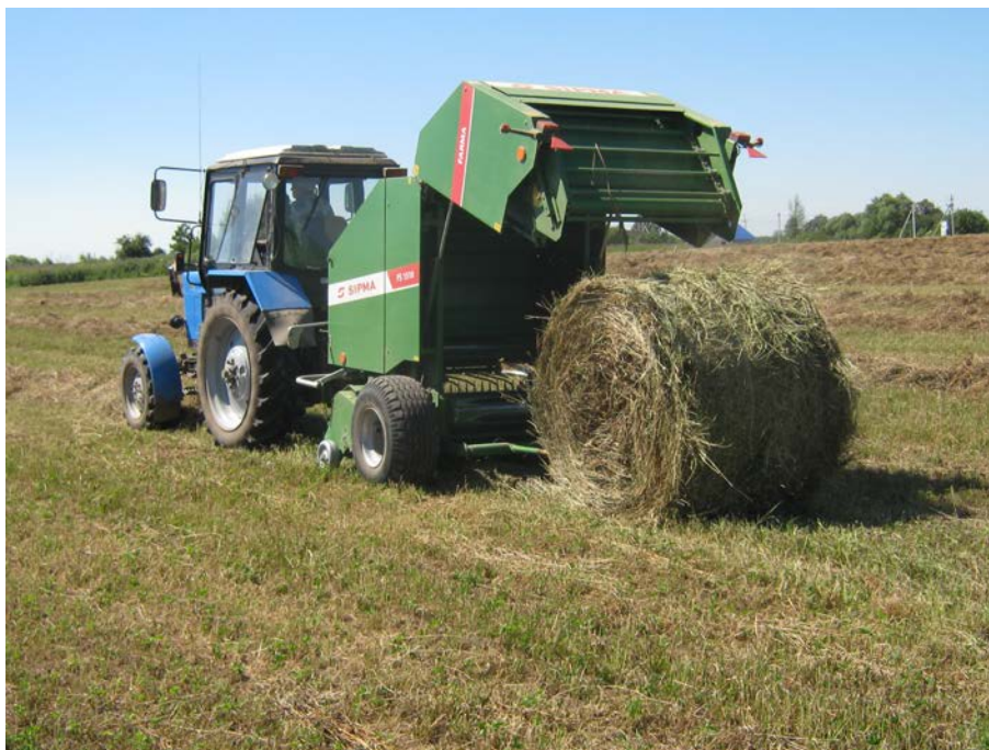
Рисунок 2 – Рулонный пресс-подборщик с постоянной камерой прессования PS 1510 «FARMA» в агрегате с трактором Беларус 82.1 в работе
