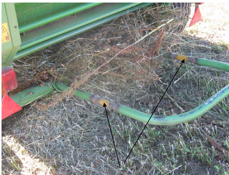
Рисунок А.1 – Рулонный пресс-подборщик с постоянной камерой прессования PS 1510 «FARMA». Увеличением длины скатов с помощью вставок
