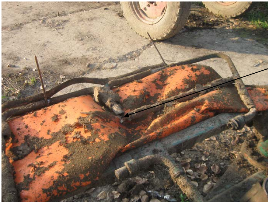
Рисунок А.6 – Косилка роторная навесная КРН-2,1. Излом трубок каркаса ограждения
