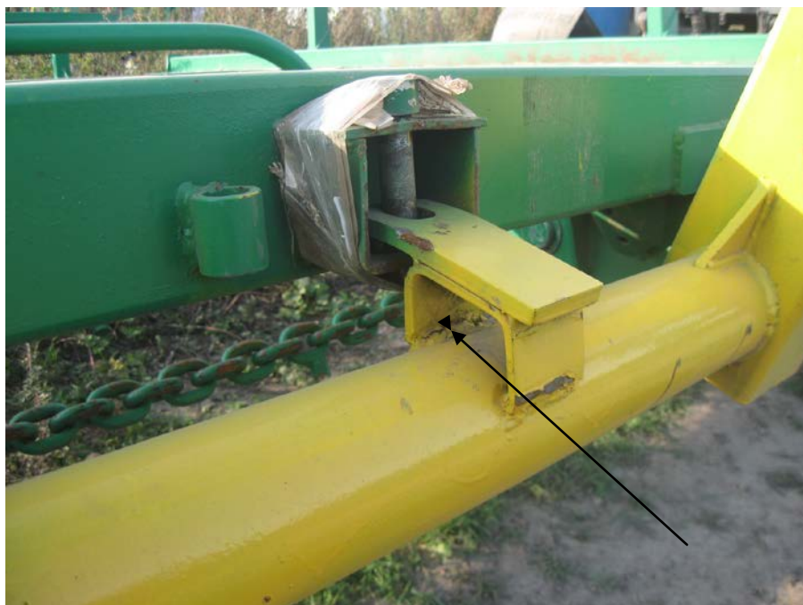
Рисунок А.10 – Погрузчик транспортировщик рулонов ТП-10. Трещина по сварке кронштейна фиксатора
