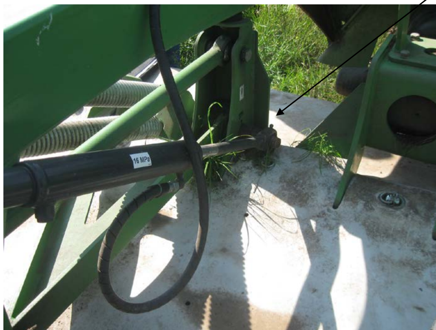
Рисунок А.2 – Косилка дисковая фронтальная KDF 340. Изгиб и поломка пальца фиксации гидроцилиндра подъёма режущего бруса. Вид после восстановления
