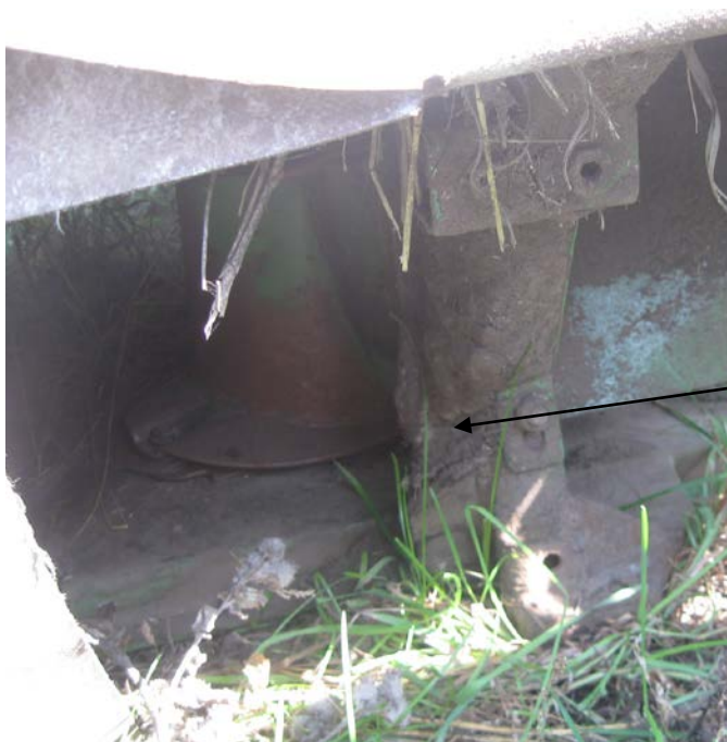
Рисунок А.3 – Косилка дисковая фронтальная KDF 340. Излом опорной стойки с правой стороны. Вид после восстановления
