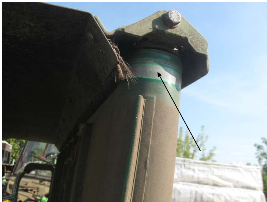
Рисунок А.1 – Комплекс косилок Giga CUT KDD 861ST. Истирание полотна транспортёра щёточным ограничителем
