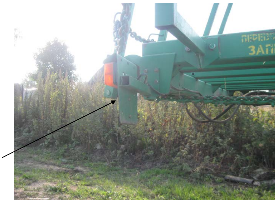
Рисунок А.7– Погрузчик транспортировщик рулонов ТП-10. Излом кронштейна заднего правого габарита.
