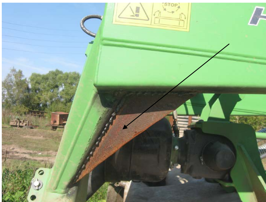
Рисунок А.4 – Косилка дисковая фронтальная KDF 340. Поломка рамки навески. Вид после восстановления
