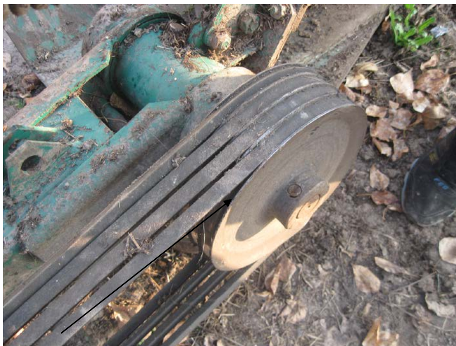
Рисунок А.5 – Косилка роторная навесная КРН-2,1. Срезание трубчатого шплинта ведущего шкива. Вид после восстановления
