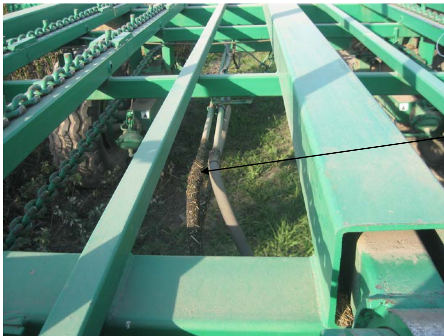
Рисунок А.9 – Погрузчик транспортировщик рулонов ТП-10. Подтекание масла из заделки гидрошланга привода транспортера
