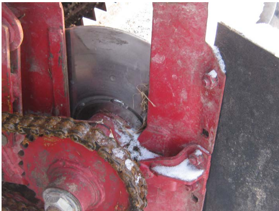
Рисунок А.5 – Комбайн кормоуборочный самоходный КСК-600. Валец приемный. Вид после замены
