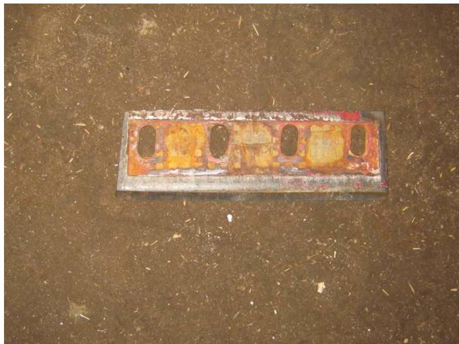
Рисунок А.2 – Комбайн кормоуборочный самоходный КСК-600. Износ режущей кромки ножа измельчающего барабана
