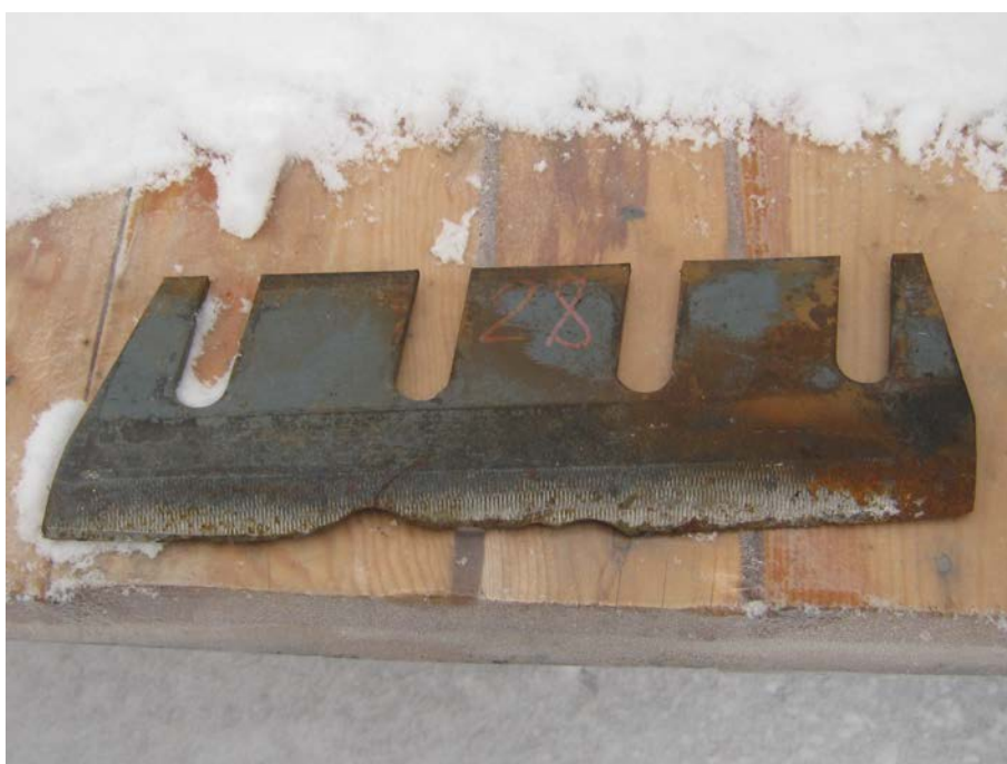
Рисунок А.6 – Комбайн кормоуборочный самоходный РСМ-100 «Дон-680М. Выкрашивание режущей кромки ножа
