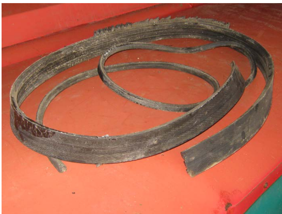
Рисунок А.4 – Комбайн кормоуборочный самоходный КСК-600. Расслоение ремня
