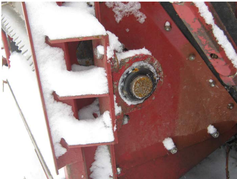
Рисунок А.7 – Комбайн кормоуборочный самоходный РСМ-1401. Вал битера проставки жатки для травы
