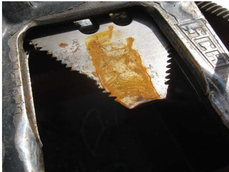
Рисунок А.1 – Комбайн кормоуборочный самоходный КСК-600. Жатка для трав КГС 0200000. Выкрашивание режущей кромки сегмента
