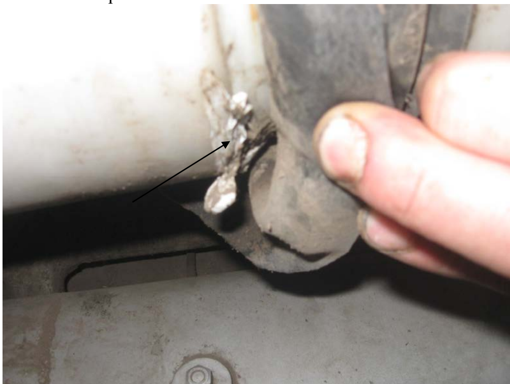
Рисунок А.4 – Комбайн зерноуборочный самоходный КЗС-1218-29 «Полессе». Заклеивание бачка и постановка резиновой прокладки
