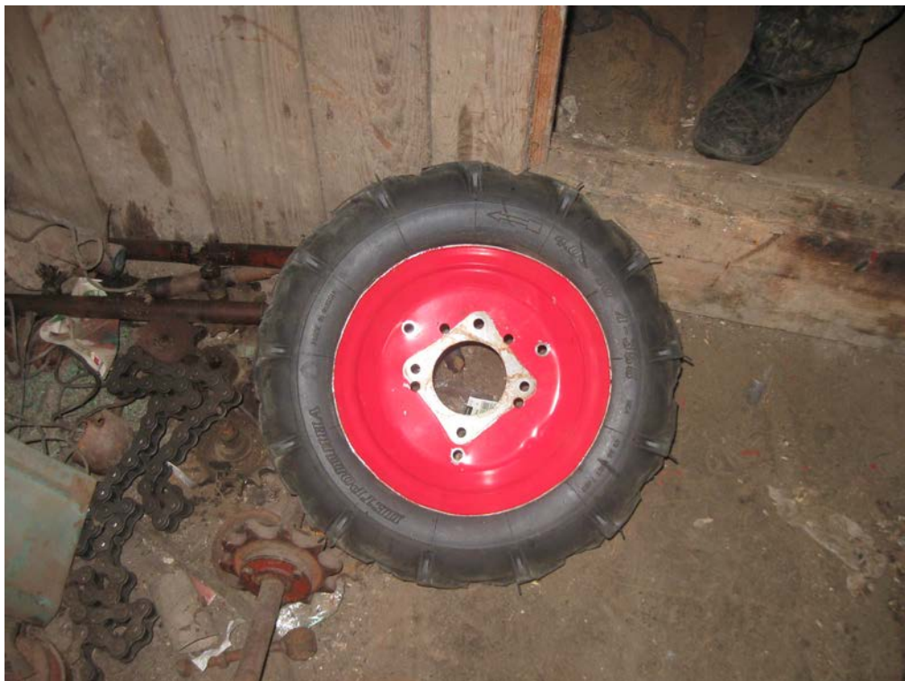
Рисунок А.5 – Зернометатель самопередвижной ЗМ-60. Место крепления дисков. Не достаточная прочность конструкции крепления дисков колеса
