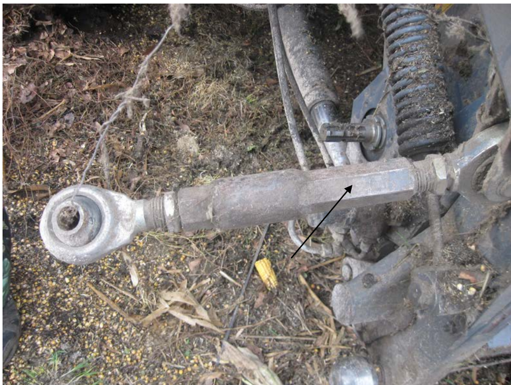
Рисунок А.3 – Комбайн зерноуборочный самоходный КЗС-1218-29 «Полессе». Изготовление резьбовой части талрепа регулировки жатки
