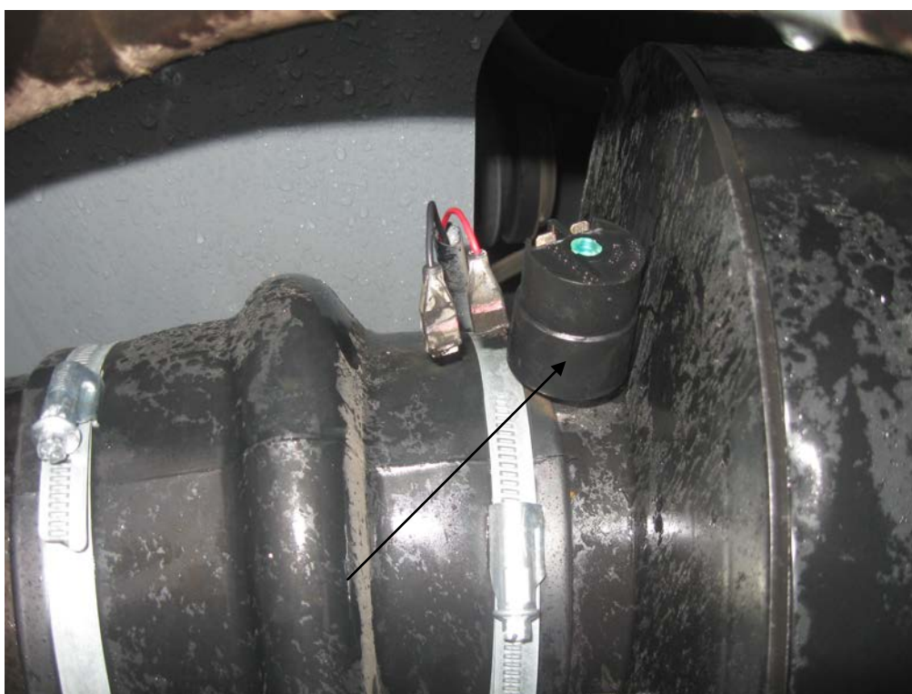
Рисунок А.2 – Комбайн зерноуборочный самоходный РСМ-142 «ACROS-530». Не работает датчик воздушного фильтра
