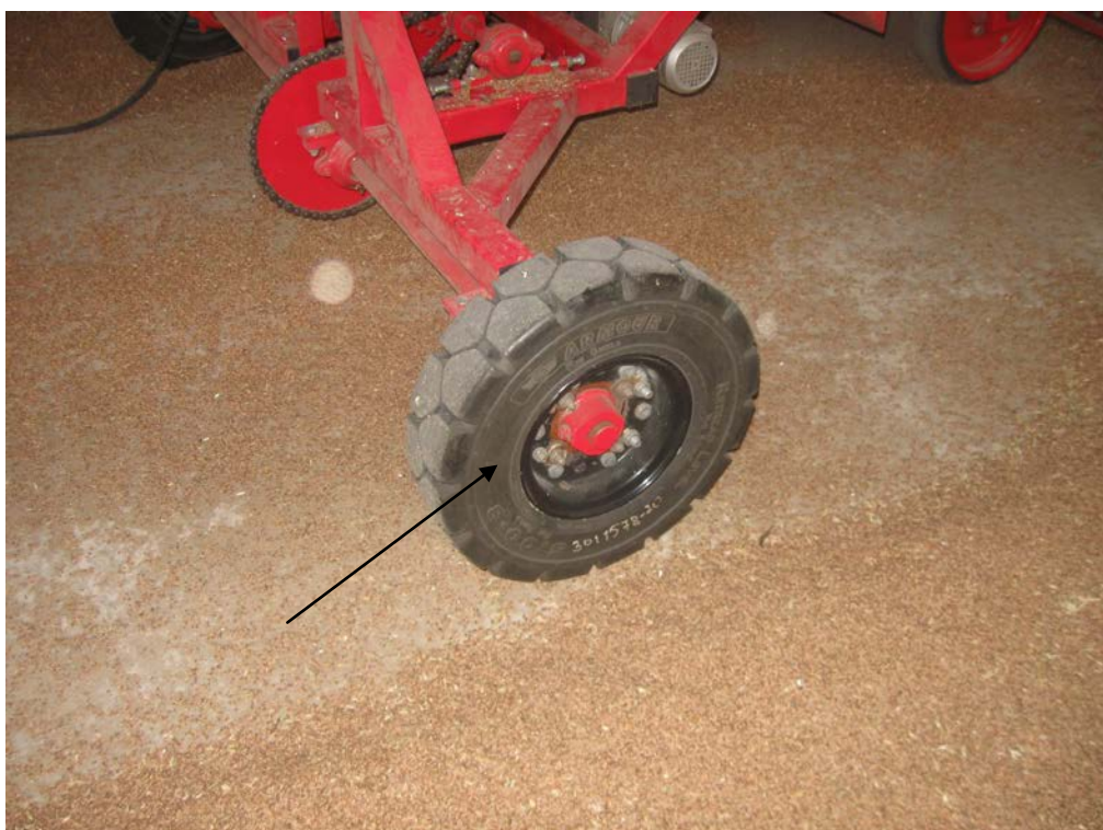
Рисунок А.6 – Зернометатель самопередвижной ЗМ-60 Замена колёс на другую конструкцию дисков с литой резиной
