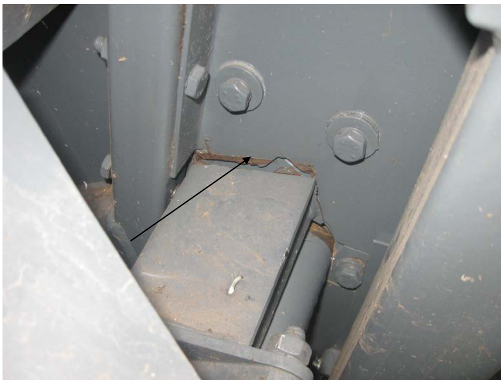
Рисунок А.1 – Комбайн зерноуборочный самоходный РСМ-142 «ACROS-580». Отрыв кронштейна крепления вала битера
