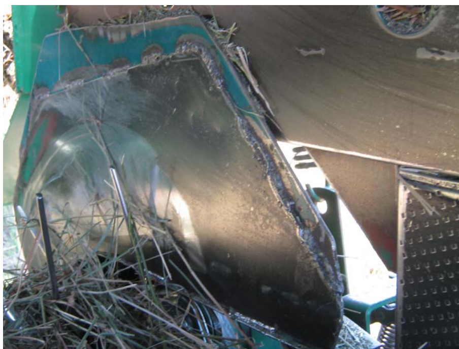
Рисунок А.1 - Пресс-подборщик рулонный ПР-Ф-145П. Изгиб боковины подборщика. Вид после восстановления
