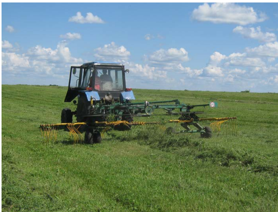
Рисунок 2 – Грабли-ворошилки роторные ГВР-630 в агрегате с трактором Беларус 82.1 в работе
