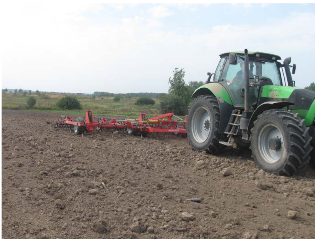
Рисунок 2 - Культиватор универсальный для сплошной обработки почвы БПК-8 в агрегате с трактором Dautz-Fahr 265 «Agrotron» в работе
