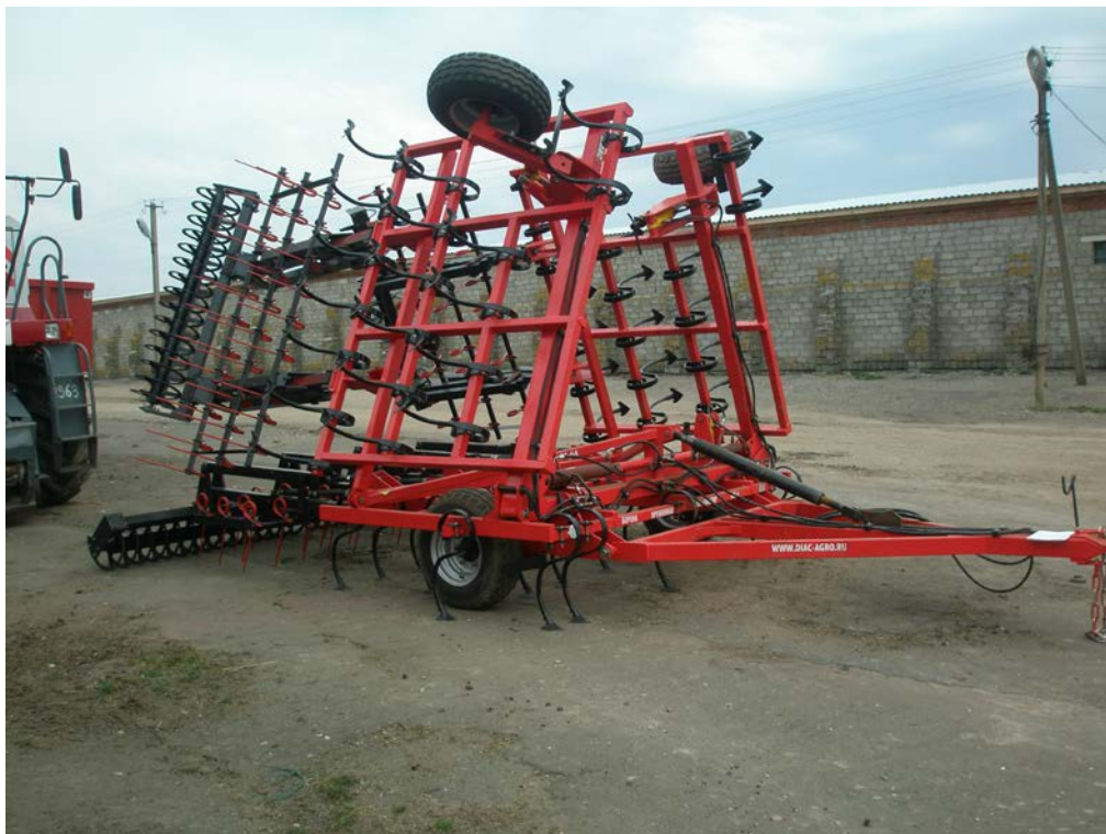
Рисунок 1 - Культиватор универсальный для сплошной обработки почвы БПК-8. Транспортное положение при хранении. Вид спереди справа
