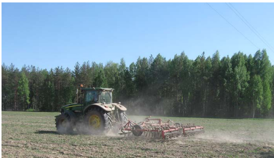
Рисунок 2 – Культиватор VIKING 6.8CH в агрегате с трактором JOHN DEERE 7830 в работе
