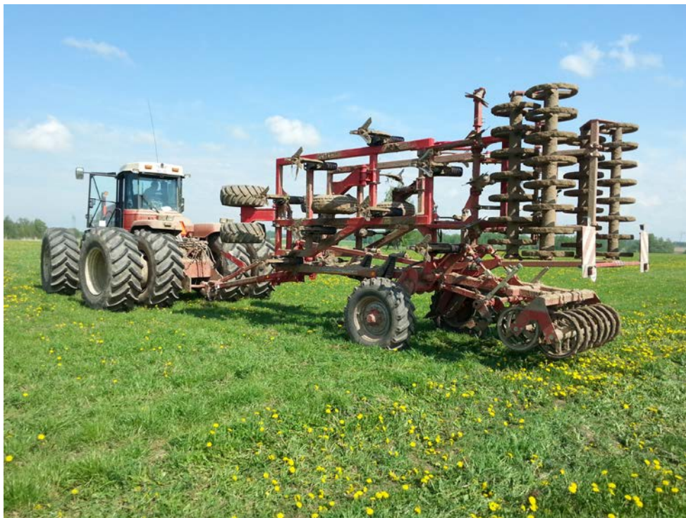
Рисунок 1 – Культиватор HORSCH Terrano 6FM в агрегате с трактором VERSATILE 2375 в транспортном положении. Вид сзади слева
