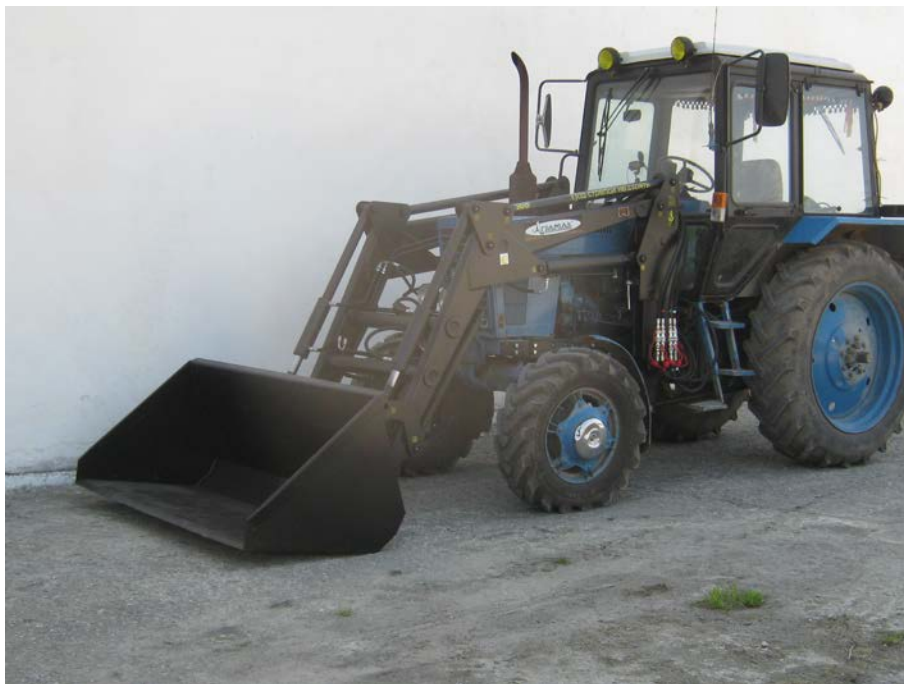
Рисунок 1 – Гидроподъёмник МКДУ-82Б с ковшом 0,8м 3 в агрегате с трактором МТЗ-82.1. Вид спереди слева
