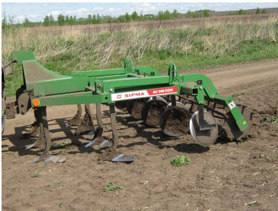
Рисунок 1 – Культиватор SIPMA AU 300 DZIK PR в рабочем положении. Вид спереди слева
