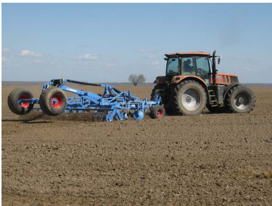
Рисунок 2 – Культиватор Lemken Kristall 9KU в агрегате с трактором АТМ 5280 Terrion в работе
