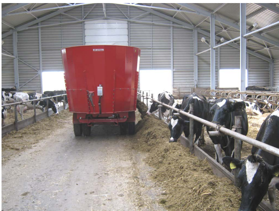
Рисунок 2 – Смеситель-кормораздатчик «FEEDER» VM14 2SB в работе на раздаче корма
