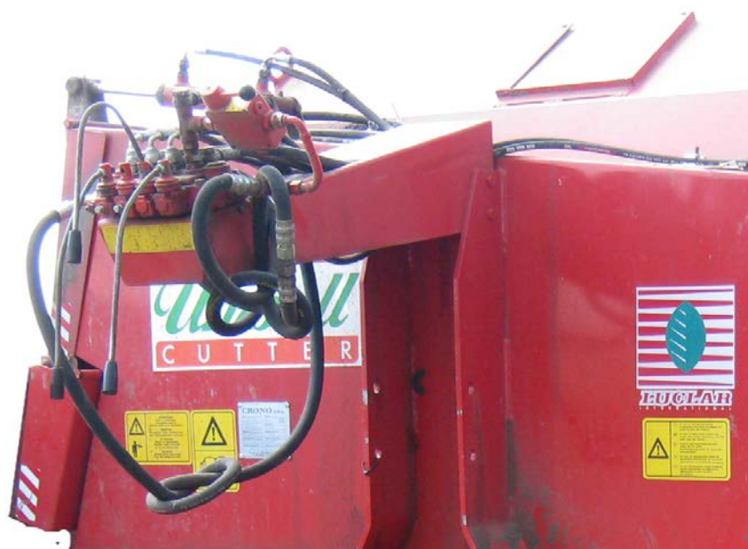
Рисунок А.1 – Дробилка-погрузчик/распределитель кормов для животных UNIBALL-1800. Изгиб рычагов управления, для удобства обслуживания из кабины трактора
