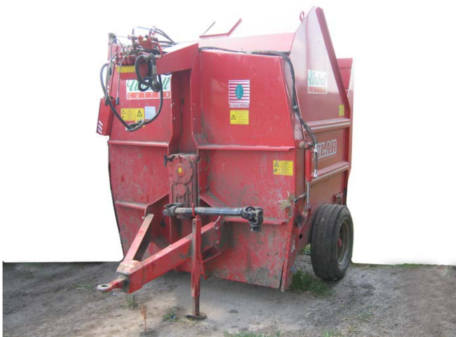
Рисунок 1 – Дробилка-погрузчик/распределитель кормов для животных «UNIBALL-1800». Вид спереди слева
