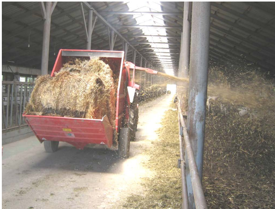
Рисунок 2 – Дробилка-погрузчик/распределитель кормов для животных UNIBALL-1800 на разбросе подстилочного материала
