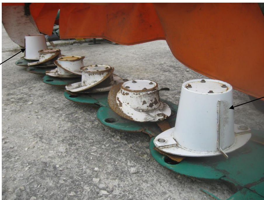
Рисунок А.1 – Косилка роторная КР-2,4М с экспериментальными кондиционерами. Установка барабанов-битеров с увеличенной высотой
