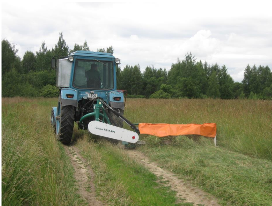
Рисунок 5 – Косилка роторная КР-2,4М с экспериментальными кондиционерами в агрегате с трактором Беларусь 82.1 на кошении сеяных злаково-бобовых трав
