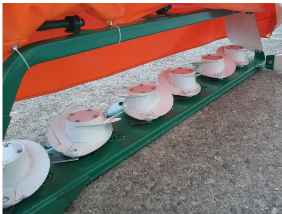
Рисунок 2 – Косилка роторная КР-2,4М с экспериментальными кондиционерами. Режущий брус с кондиционерами - аэраторами
