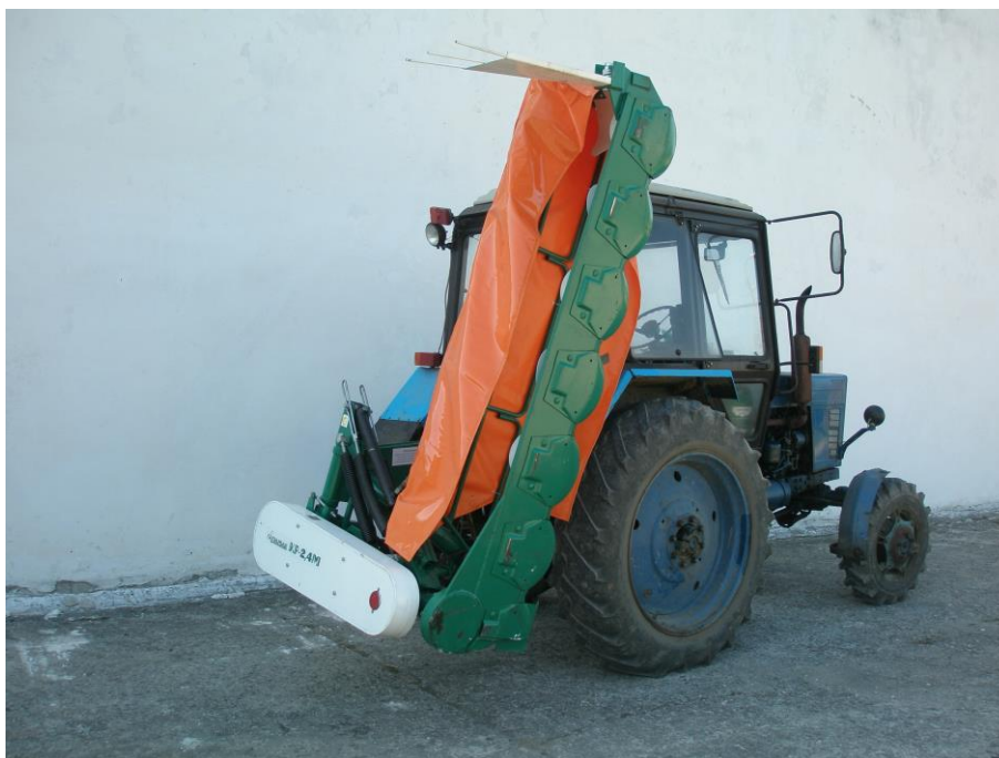
Рисунок 6 – Косилка роторная КР-2,4М с экспериментальными кондиционерами в агрегате с трактором Беларусь 82.1 в транспортном положении
