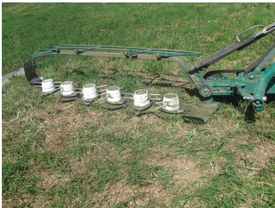
Рисунок 4 – Косилка роторная КР-2,4М с экспериментальными кондиционерами. Режущий брус с пружинными кондиционерами (билами)
