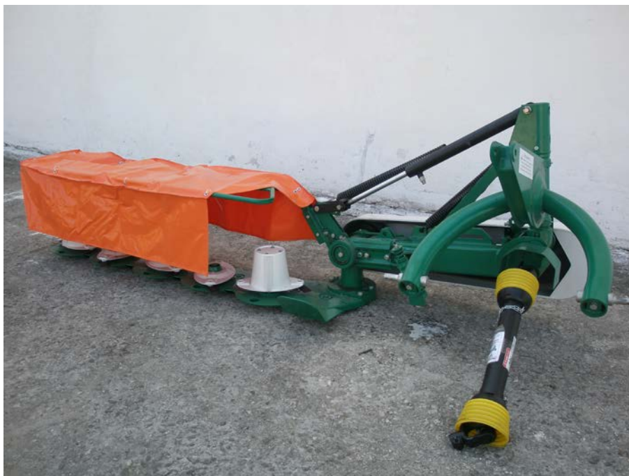
Рисунок 1 – Косилка навесная роторная с шестеренчатым приводом КР-2,1М. Общий вид спереди слева
