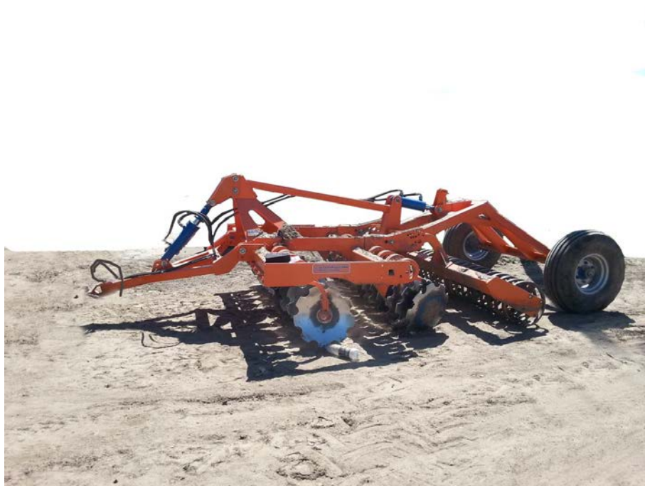
Рисунок 1 – Дисковый мульчировщик ДМ-3х2ПНМ. Вид спереди слева
