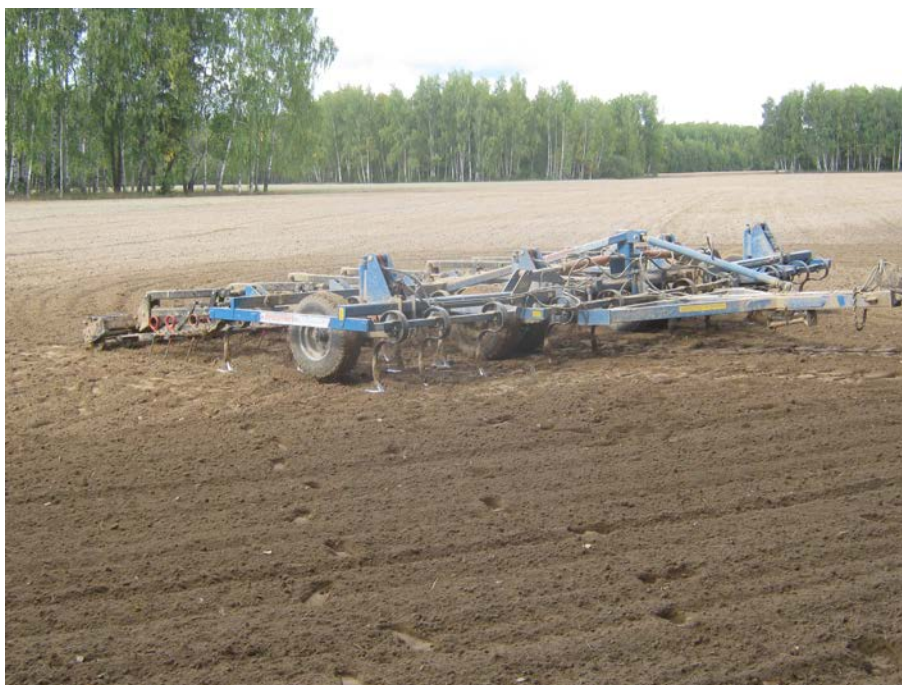
Рисунок 1 – Культиватор полуприцепной для сплошной обработки почвы КСО-8 в рабочем положении. Вид спереди справа
