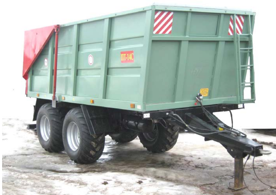
Рисунок 1 – Полуприцеп тракторный самосвальный ПТ-14С. Вид спереди справа
