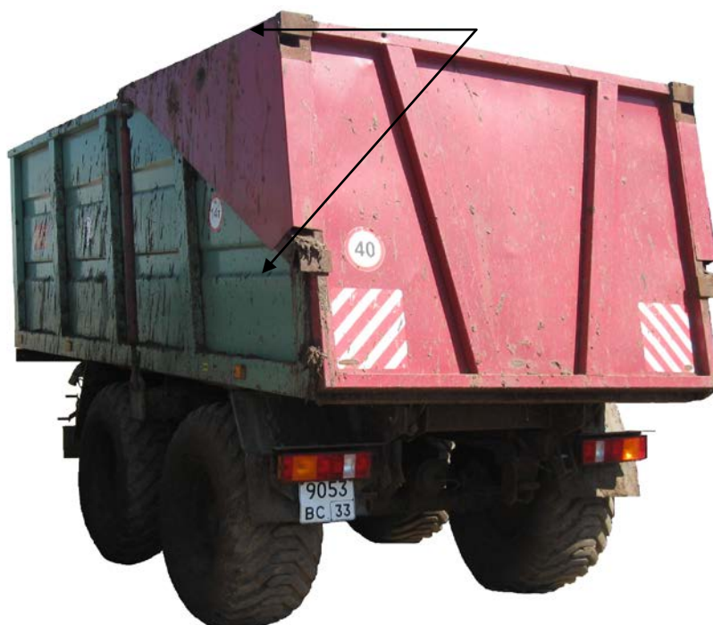
Рисунок А. 1 - Полуприцеп тракторный самосвальный ПТ-14С. Установка пластин для увеличения жесткости креплений заднего клапана кузова
