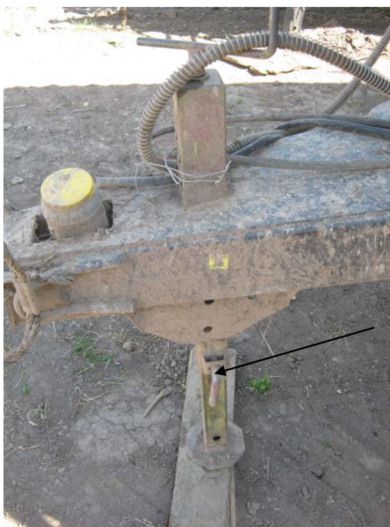
Рисунок А. 1 - Полуприцеп тракторный самосвальный ПТ-14С. Установка пластин для увеличения жесткости креплений заднего клапана кузова
