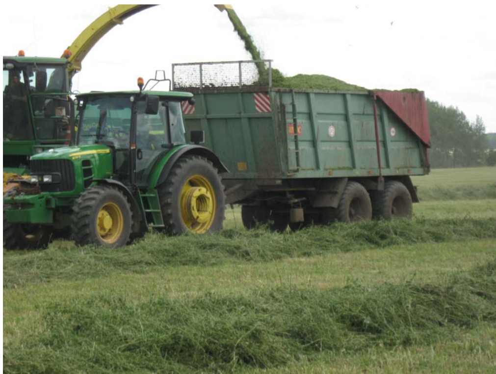
Рисунок 2 – Полуприцеп тракторный самосвальный ПТ-14С в агрегате с трактором John Deere 6130 в работе
