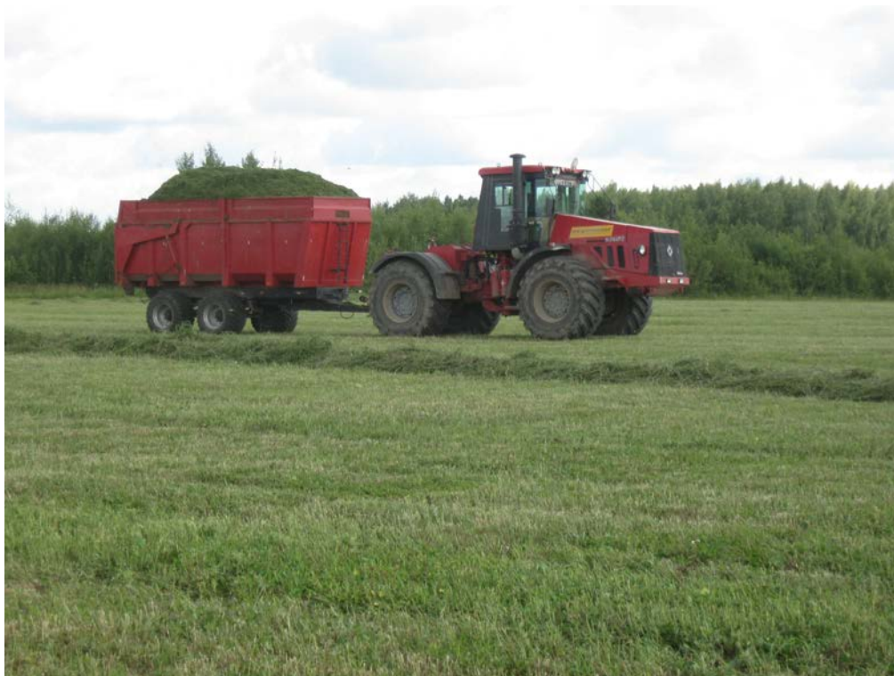
Рисунок 2 – Полуприцеп тракторный самосвальный LMR-18 в агрегате с трактором К-744Р2 на перевозке зелёной массы
