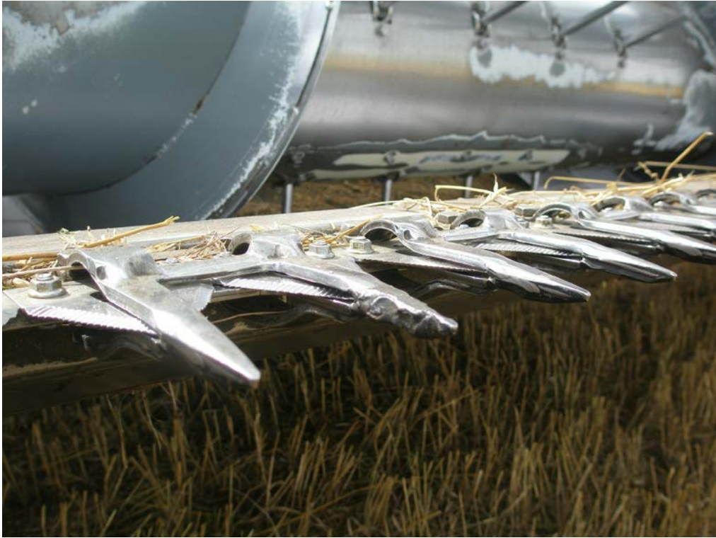
Рисунок 5 - Комбайн зерноуборочный самоходный РСМ-142 «ACROS-580» Излом пальца. Вид после восстановления, ремонт электросваркой
