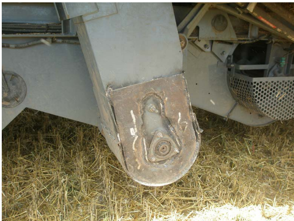
Рисунок 2 - Комбайн зерноуборочный самоходный РСМ-142 «ACROS-580» Усиление кожуха зернового элеватора, наложением пластины
