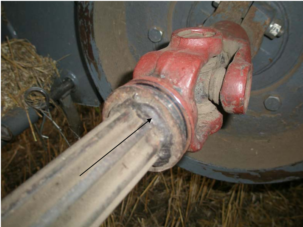
Рисунок 4 - Комбайн зерноуборочный самоходный РСМ-142 «ACROS-580» Отрыв вилки карданного вала привода мотвила Вид после восстановления
