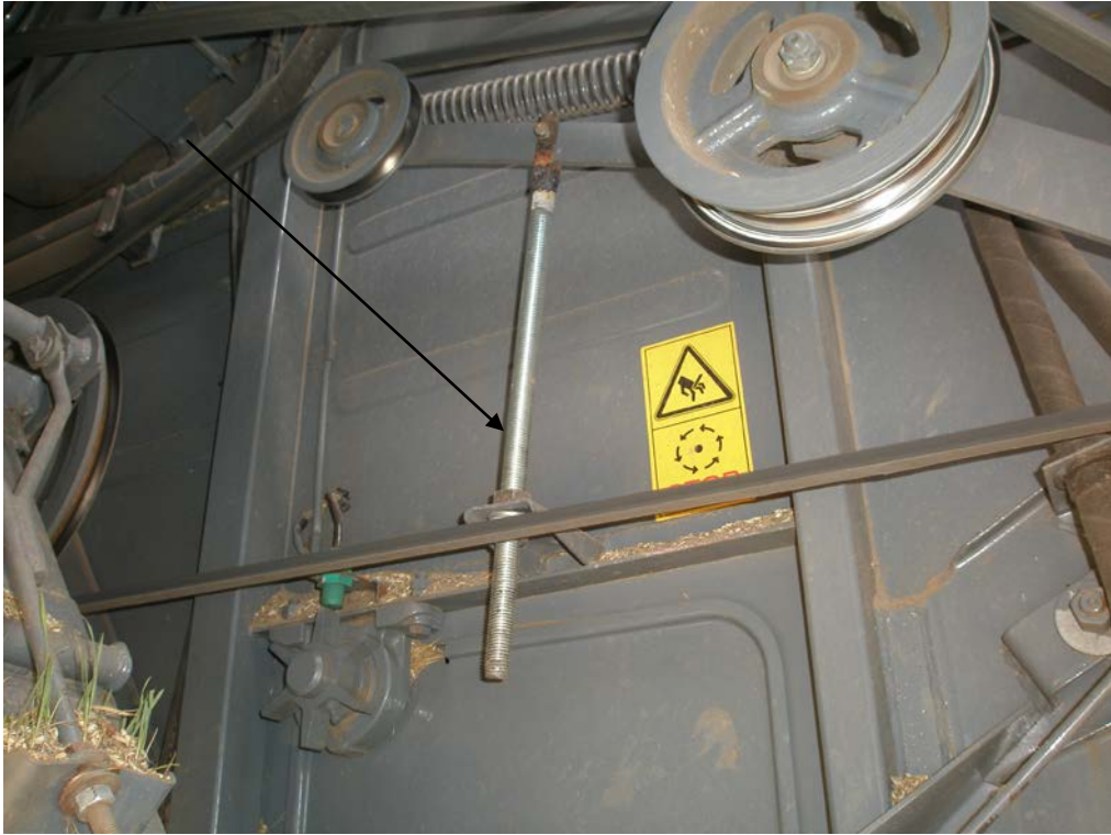
Рисунок 3 - Комбайн зерноуборочный самоходный РСМ-142 «ACROS-580» Замена тяги натяжителя ремня колосового элеватора на больший диаметр
