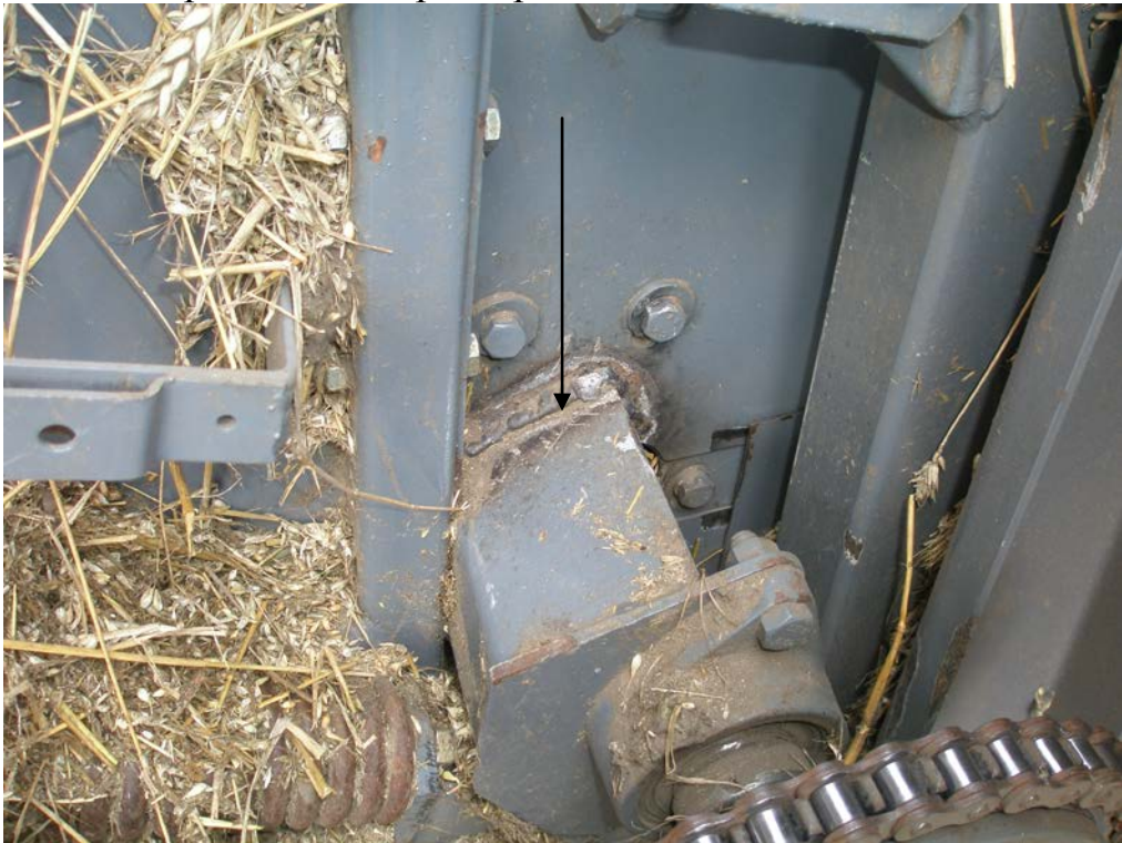
Рисунок 6 - Комбайн зерноуборочный самоходный РСМ-142 «ACROS-580» Вид после восстановления электросваркой кронштейна приёмочного шнека
