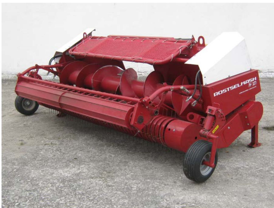
Рисунок 1 – Подборщик кормоуборочный ПФ-307. Вид спереди слева
