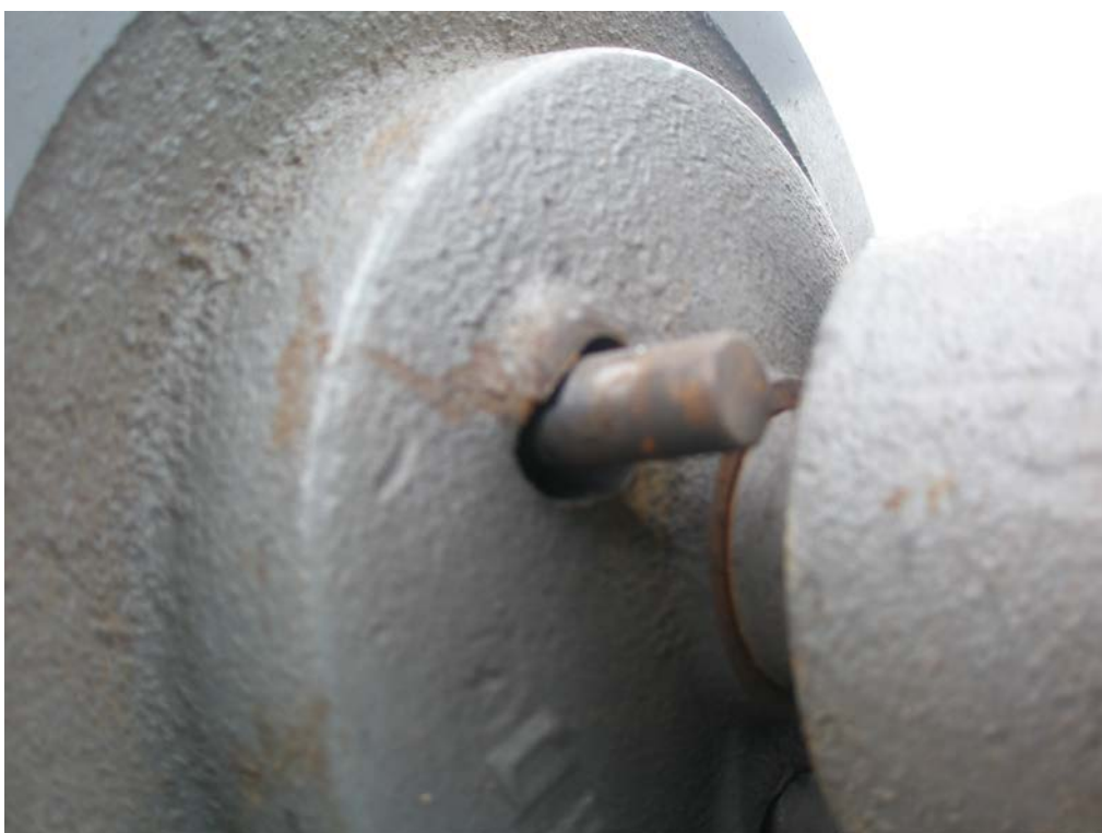
Рисунок 2 - Комбайн зерноуборочный самоходный СК-5 МЭ - «Нива-Эффект». Износ направляющих отверстий вариатора мотовила
