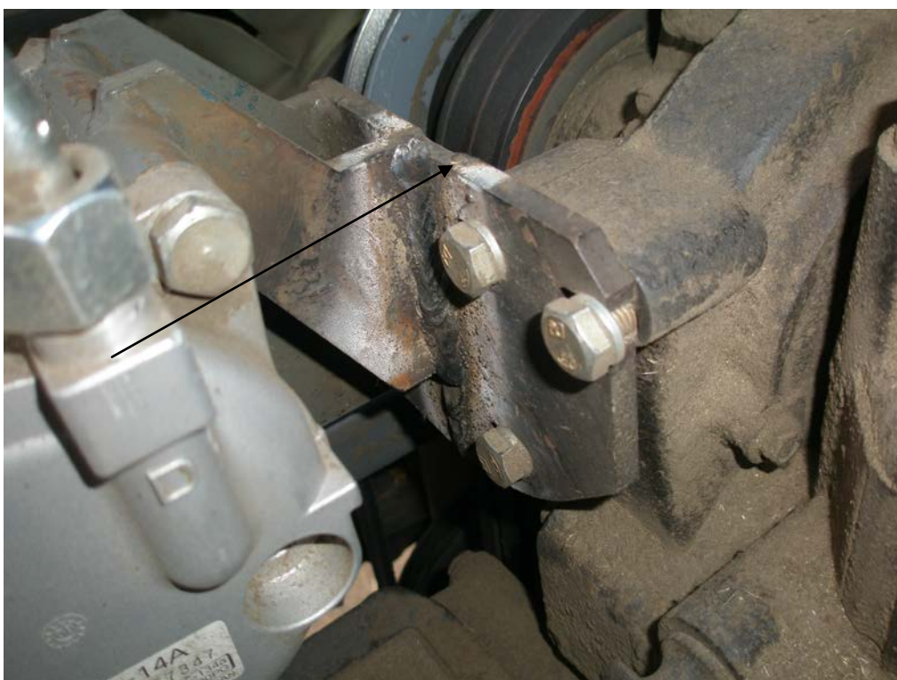
Рисунок 4. Комбайн зерноуборочный самоходный СК-5 МЭ - «Нива-Эффект». Излом кронштейна крепления компрессора кондиционера по сварочному шву
