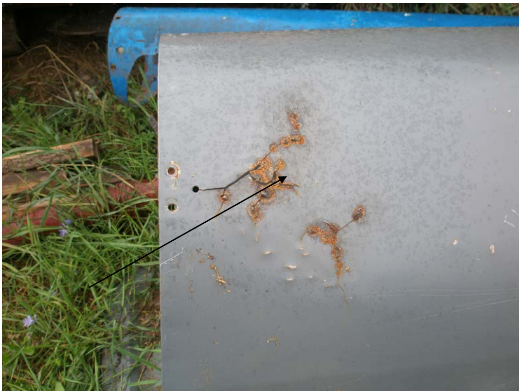
Рисунок 5 - Комбайн зерноуборочный самоходный СК-5 МЭ - «Нива-Эффект». Трещина кожуха вентилятора
