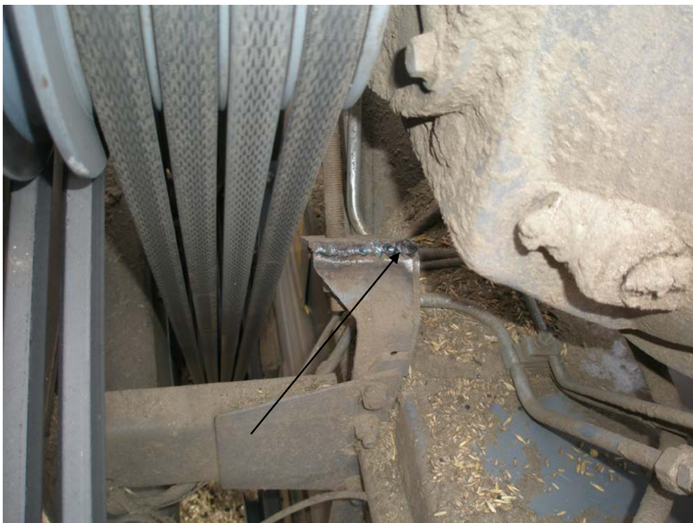
Рисунок 6 - Комбайн зерноуборочный самоходный СК-5 МЭ - «Нива-Эффект» Излом кронштейна натяжения ремня контрпривода
