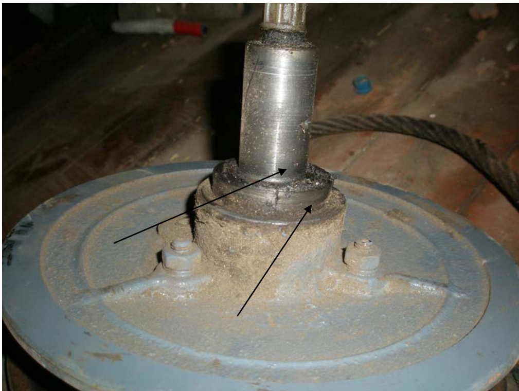
Рисунок 3 - Комбайн зерноуборочный самоходный СК-5 МЭ - «Нива-Эффект». Трещина втулки вариатора мотовила
