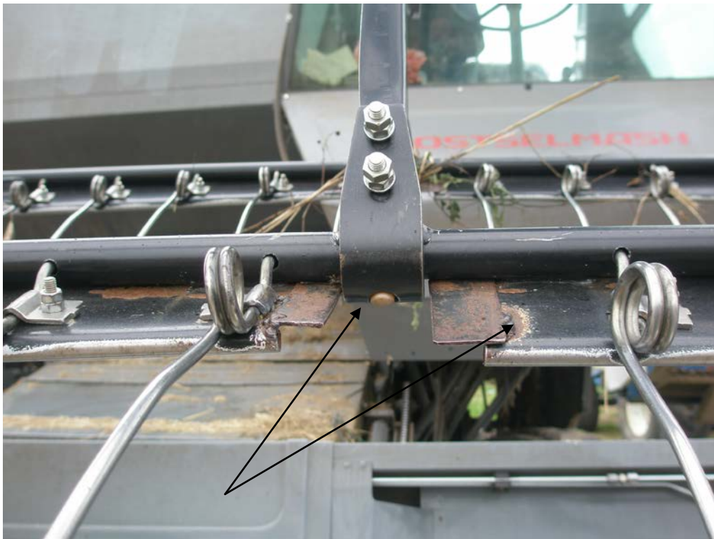
Рисунок 1 - Комбайн зерноуборочный самоходный СК-5 МЭ - «Нива-Эффект». Ликвидация зазора при помощи приварки пластины
