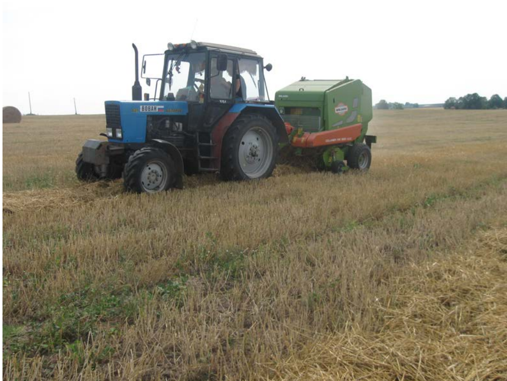
Рисунок 2 - Рулонный пресс-подборщик WOLAGRI R 12/2000 EVO в агрегате с трактором Беларус-82.1 в работе
