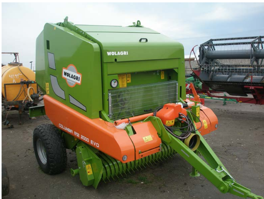
Рисунок 1 - Рулонный пресс-подборщик WOLAGRI R 12/2000 EVO Вид спереди справа
